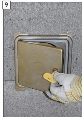
9 BlowerDoor-Türblatt mit dem PT-Schlüssel öffnen und aushängen.
