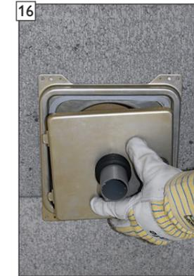
16 BlowerDoor Türblatt mit Dichtgummi auf das montierte HT-Rohr aufschieben, einhängen und verschließen.
